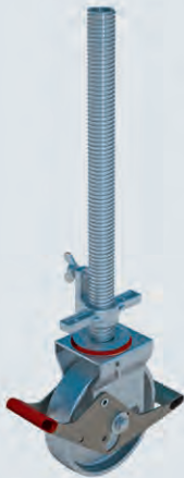
Lenkrolle 10,0 kN, Ø 200 mm Bauhöhe: 241 mm zzgl. Spindel 500 mm Gebremster Zustand: 1.000 kg Fahrlast ca. 400 kg (bei ebenem Untergrund)
