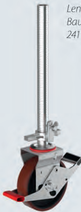
Lenkrolle 10,0 kN, Ø 200 mm Bauhöhe: 241 mm zzgl. Spindel 500 mm Gebremster Zustand: 1.000 kg Fahrlast ca. 400 kg (bei ebenem Untergrund)
