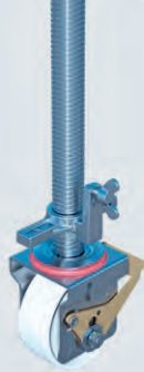
Lenkrolle 3,0 kN, Ø 150 mm Bauhöhe: 180 mm zzgl. Spindel 320 mm
